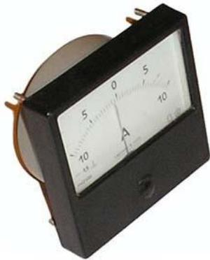
Амперметр М42300 предназначен для измерений тока в электрических цепях постоянного тока. Приборы представляют собой щитовые приборы магнитоэлектрической системы с внутрирамочным магнитом; Измерительный механизм прибора состоит из магнитной системы (обойма, магнитопровод), отсчетного устройства (шкала, указатель) и подвижной части на кернах;
