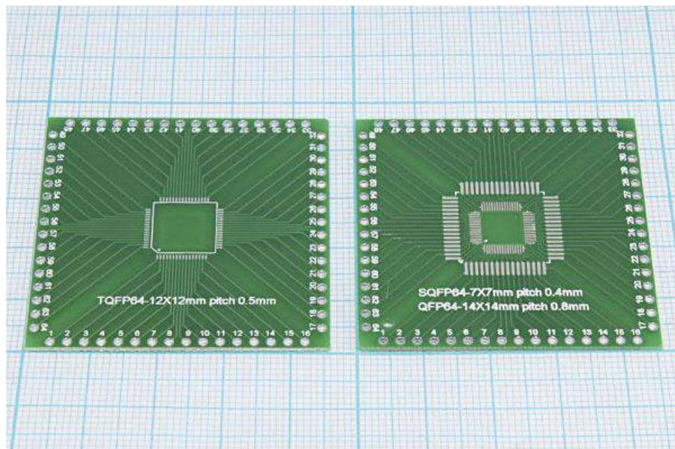
Размер 46мм\*46мм. Переходник двухсторонний. С одной стороны посадочное место под корпус TQFP64 с шагом выводов 0.5мм, с другой стороны переходника посадочное место под микросхему в корпусе QFP64 с шагом выводов 0.8мм и SQFP64 с шагом выводов 0.4мм. Отверстия металлизированные. Шаг отверстий 2,54мм. Материал FR-4. Толщина 1 мм.
