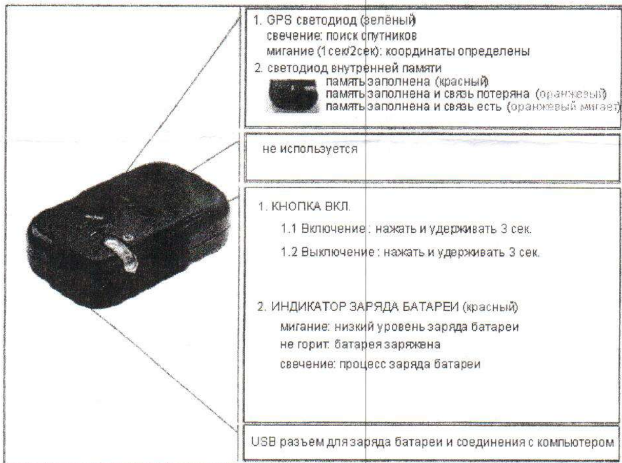
Рис. 1. Вид устройства и функции светодиодов.
