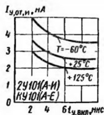
Зависимости отпирающего импульсного тока управления от времени включения
