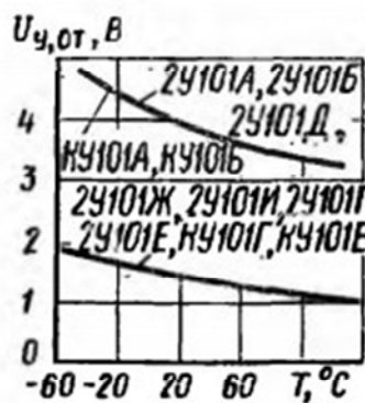
Зависимости отпирающего постоянного напряжения управления от температуры
