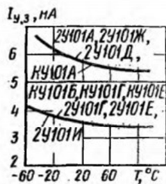
Зависимости отпирающего постоянного тока управления от температуры
