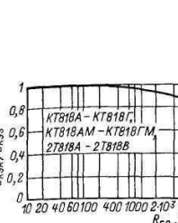
Зависимость относительного напряжения коллектор-эмиттер от сопротивления база-эмиттер.
